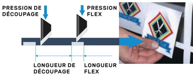
Alternativement un segment est découpé à travers la matière et un segment est coupé partiellement. De ce fait, la matière garde suffisamment de rigidité pour être transportée correctement sur le plotter tout en offrant à l'utilisateur la possibilité de récupérer aisément son dessin en cassant les points d'ancrage.
